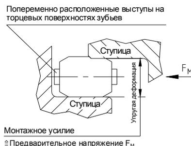
Рис. 9: Предварительное напряжение зубчатого венца
